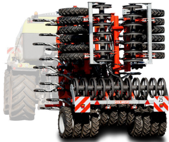
Abb.: APER G6000, geklappt mit U-Ring-Walzen.
