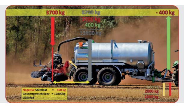
Die rote Linie markiert den Schwerpunkt/Gleichgewichtspunkt der Kurzscheibenegge. Das bedeutet, an dieser Stelle kann die Maschine mit einem Kran austariert angehoben werden.
